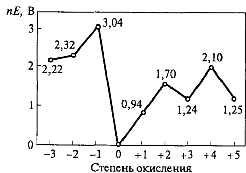
Рис. 32. Фрагмент диаграммы Фроста для азота при pH 14 (указаны значения вольт-эквивалентов для соответствующих степеней окисления)
